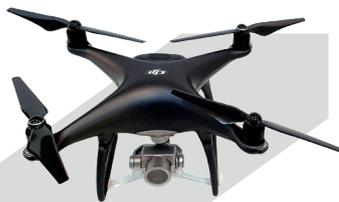
**Le drone** est équipé d'une **caméra haute définition** le drone permet l'analyse photogramétrique des parties non accessibles d'un site depuis le sol.
