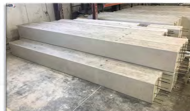
Longrines décollées pour plancher poutre
