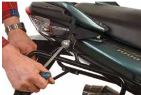
2. Dévisser la vis Lock-it supérieure
