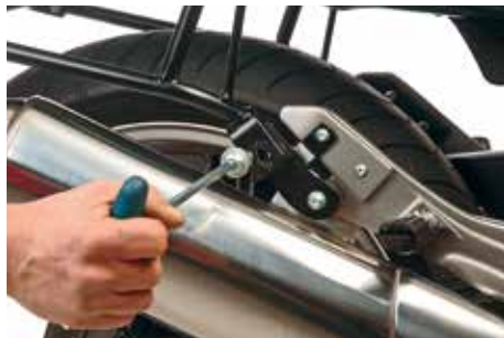
1. Dévisser la vis Lock-it inférieure
