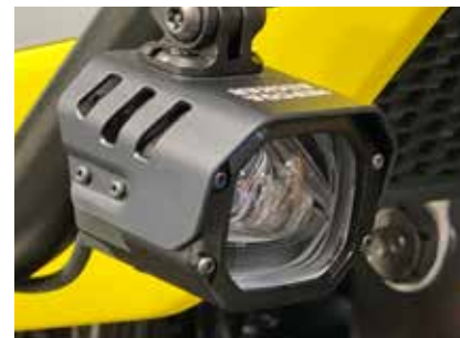
Boîtier en aluminium avec écran de protection
