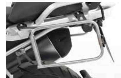
Porte-bagage vissé Surface sablée et électropolie
