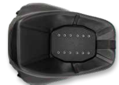
La plaque de base avec possibilité de réglage variable de l'adaptateur permet le meilleur positionnement de l'EPIC sur ta moto.
