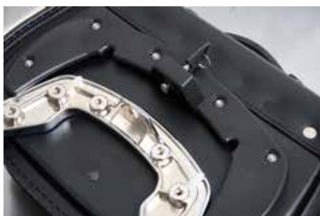
Sacoche Street sécurisée au support C-Bow à l'aide d'une serrure
