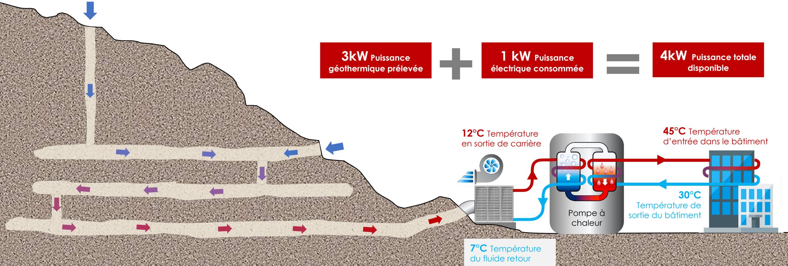
Exemple de fonctionnement en géothermie sur nappe avec une pompe à chaleur d'un COP de 4.
