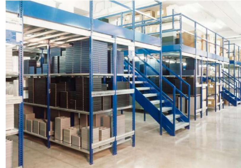
Les structures à plusieurs étages avec passerelles intermédiaires sont le système le plus pratique, le plus fonctionnel et le plus économique pour doubler, voire tripler la surface de stockage ou d'archivage.
