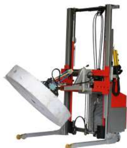
Potence pour retourner de bobines « ROTO-BOBINE » sur gerbeur LEV 600 – Capacité 350 kg Pour - Ø mandrin: 70 - 76 mm - Ø extérieur maxi 1200 mm, laize maxi 400 mm* Autres dimensions, nous consulter ! Versions : manuelle - levée et rotation électriques - levée et rotation électriques avec déplacement motorisé
