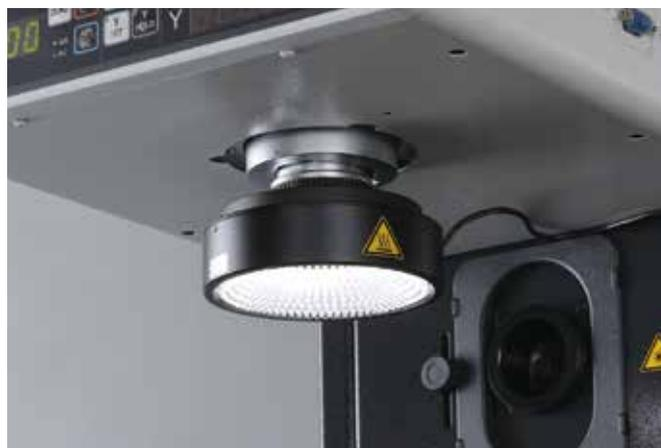
Exemple d'installation de l'éclairage circulaire LED sur le projecteur PJ-PLUS
