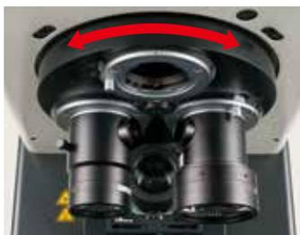
La tourelle du PJ-H30 est dotée de roulements à faible frottement qui assurent un mouvement rotatif régulier et rapide pour positionner les différents objectifs de projection sur la trajectoire de la lumière et changer ainsi le grossissement. Les montures à baïonnette permet une installation et un démontage rapides des objectifs.
