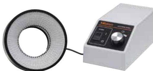
L'éclairage LED accentue le contraste des images projetées de la pièce, facilitant la mesure stéréoscopique et l'observation. L'image projetée peut ainsi être observée avec une reproductibilité élevée des couleurs pour une faible consommation d'énergie : 17,4 W. La durée de vie atteint les 30 000 heures.
