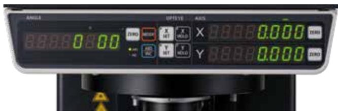
Le compteur numérique (axes X, Y et angle) intégré de série sur tous les modèles est doté d'un afficheur à LED haute luminosité et grands caractères qui garantit une excellente visibilité dans tous les environnements. En plus des fonctionnalités de mise à zéro et de changement de direction, le projecteur est doté d'une sortie RS-232C pour les valeurs du compteur. Résolution : 0,001 mm ou 0,0001 in / 0,001 mm\*
