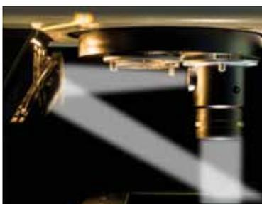
L'éclairage épiscopique est constitué d'un éclairage vert, qui traverse l'objectif de projection, et d'un éclairage oblique à angle réglable, de série. Il s'avère particulièrement efficace pour l'observation en 3D pour laquelle il offre une meilleure reproductibilité des couleurs.
