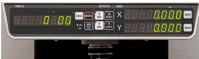
Le compteur numérique (axes X, Y et angle) intégré de série sur tous les modèles est doté d'un afficheur à LED haute luminosité et grands caractères qui garantit une excellente visibilité dans tous les environnements. En plus des fonctionnalités de mise à zéro et de changement de direction, le projecteur est doté d'une sortie RS-232C pour les valeurs du compteur. Résolution : 0,001 mm ou 0,0001 in/0,001 mm
