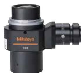
L'objectif de projection est équipé d'une monture C qui permet d'utiliser également une caméra numérique compatible. Les fonctionnalités du projecteur de profil (PJ-H) peuvent être complétées. Il est par exemple possible d'observer une pièce sur l'écran de projection de grandes dimensions et de capturer l'image en couleur avec la caméra pour l'observer sur l'écran de l'ordinateur.
