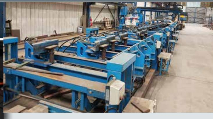
**Robot de soudure deux têtes**
