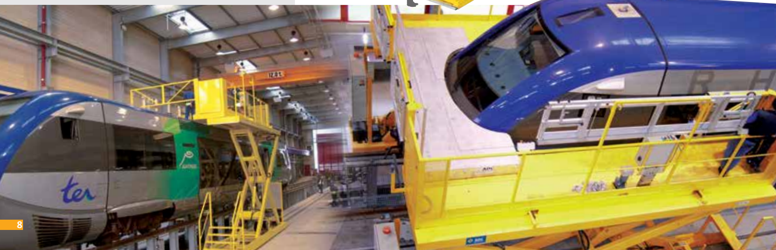
PEMP pour la maintenance des trains ou des bus Double table for train & bus maintenance
