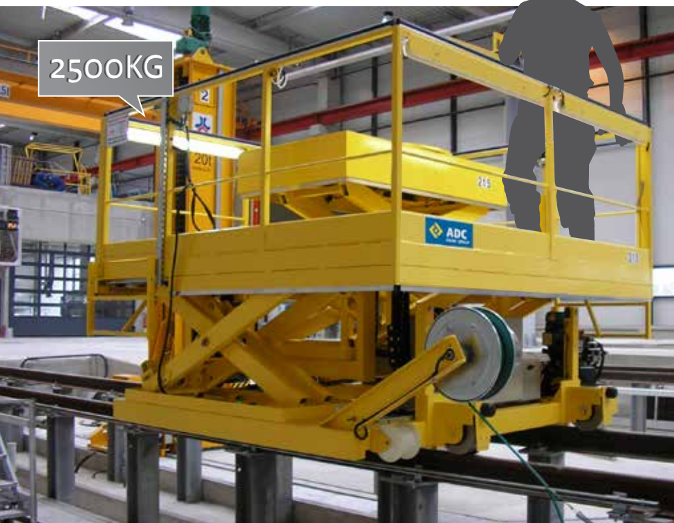
Maintenance de trains : table pour dépose d'organes. Dimensions 3000 x 3000 mm Train maintenance: Lifting table for underbody equipment. Dimensions 3000x3000mm
