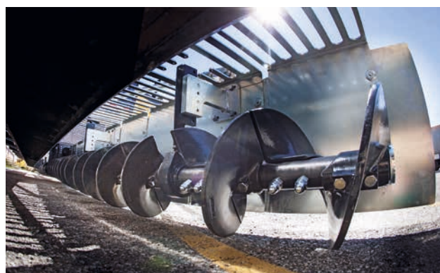
Vis sans fin de 400 mm en fonte résistante à l'usure.
