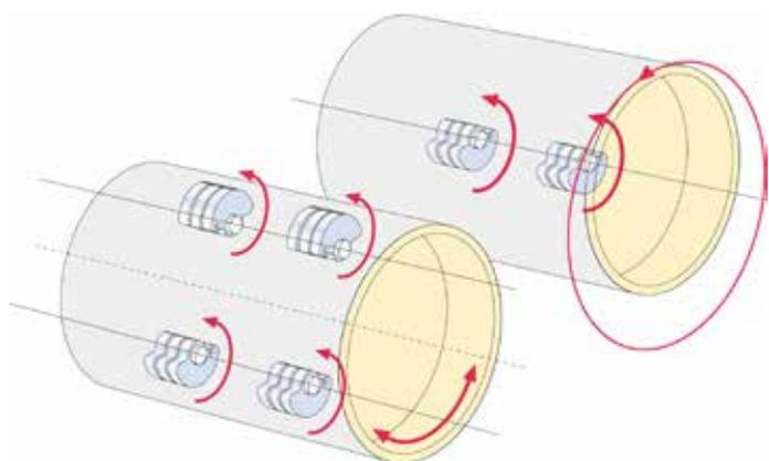
Le rouleau Dynapac CO4200VI possède un cylindre vibrant avec deux amplitudes de vibration et un cylindre oscillant.
