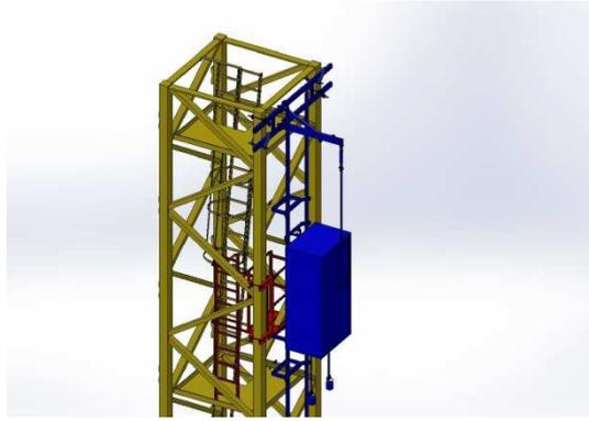
**Schéma n°3 - Vue d'ensemble mâtresse-accès motorisé AMG-Tumac à poulies et câbles**
