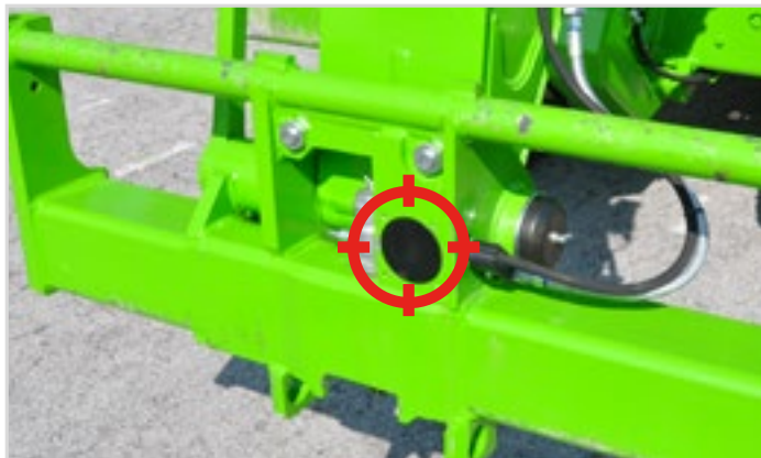
Capteur placé sur le tablier
