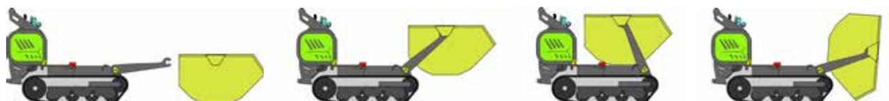
Le dispositif breveté de fixation rapide des équipements, qui prévoit la présence de deux bras mécaniques robustes sur le chariot, est le fondement technologique du Cingo Multifonction. La plupart des équipements du système multifonction sont compatibles avec ce dispositif.
