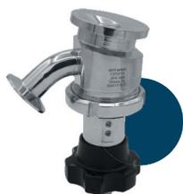
La vanne à membrane fond de cuve est conçue pour être soudée au fond d'une cuve. Elle favorise l'écoulement du fluide grâce à son inclinaison et à son cône de drainage. L'angle de la sortie assure également l'absence de rétention avec un drainage du fluide dans la vanne. On retrouve le robinet fond de cuve en version manuelle et aussi en version motorisée pneumatique pour faciliter son utilisation dans les zones difficiles d'accès ou pour automatiser le procédé.
