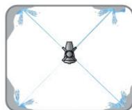
Les buses sont positionnées sur une roue ce qui permet d'avoir une double rotation contrôlée. Les jets qui en résultent sont puissants et balaient toute la surface du réservoir selon un modèle prédéfini et un temps minimal. Ces têtes de classe de lavage 5 restent la solution la plus efficace dans le cas de récurage de très grandes cuves ou de cuves avec un degré de salissure élevé (modèle 8084).
