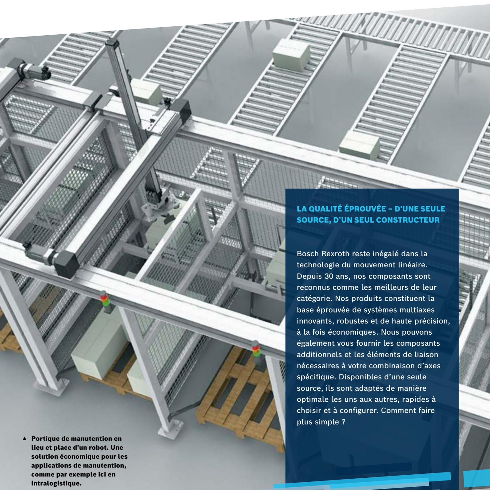
▲ Portique de maintenance en lieu et place d'un robot. Une solution économique pour les applications de maintenance, comme par exemple ici en intralogistique.
