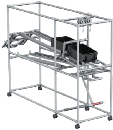
Karakuri - L'énergie cinétique pour l'approvisionnement ergonomique aux postes de travail
