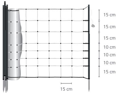
Un rouleau de 50 m de filet électrifié conçu spécialement pour répondre aux besoins des moutons.
