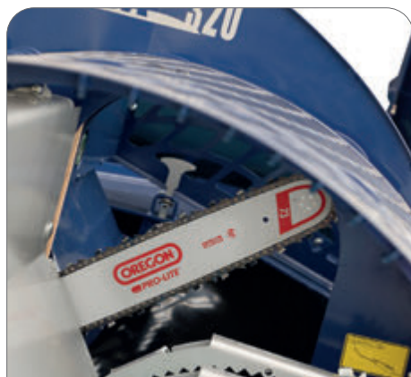
La chaîne ne tourne que pendant l'opération de sciage.
