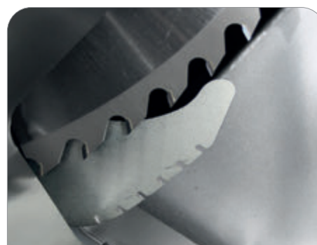
Bras de maintien qui bloque le bois pendant le sciage
