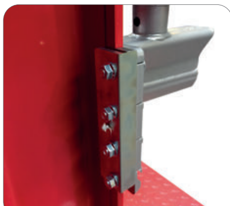
Glissières en laiton avec graisseurs
