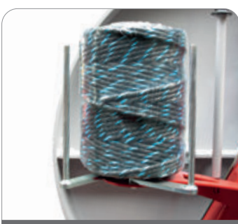
Support de bobine à diamètre réglable
