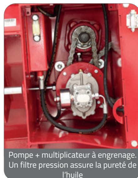
Système électro-hydraulique protégé par le bâti du treuil
