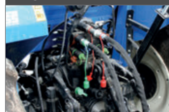
Branchement hydraulique directement sur le tracteur
