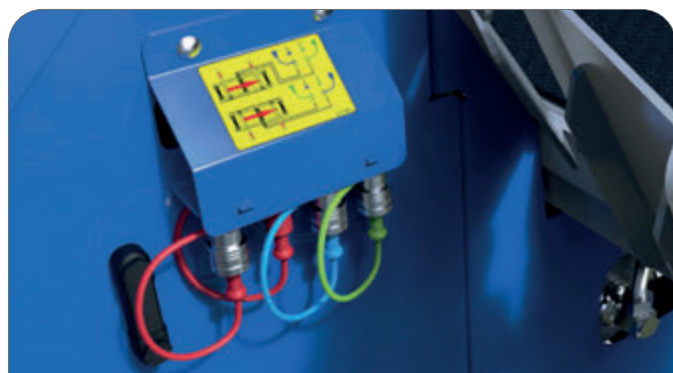
Sortie hydraulique pour deck ou autres accessoires.
