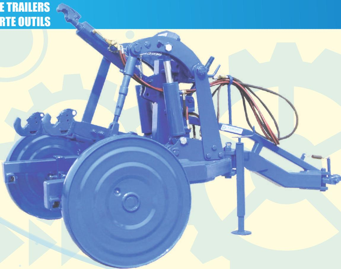
**IT - Il telaio** è strutturato in modo da avere una disposizione delle masse che non genera fenomeni di impuntamento e di slittamento nella trattrice garantendone la massima aderenza al suolo e il minimo sforzo di trazione. **Il timone spostabile** permette anche l'aratura fuori solco.
