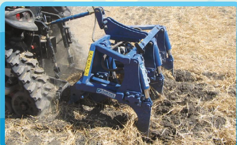
**IT - Il telaio**, piccolo, robusto e molto versatile, è dotato di attacchi regolabili, che mantengono l'attrezzo molto vicino alla trattrice offrendo un notevole vantaggio nella movimentazione.
