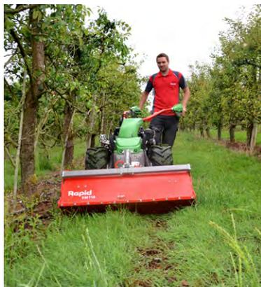
Les débroussailleuses à fléaux de Rapid coupent et hachent finement l'herbe comme les broussailles, et répartissent les produits coupés uniformément sur le sol. Les couteaux en Y extrêmement résistants et montés de manière mobile sur l'arbre équilibré permettent un travail sans vibration avec une grande efficacité. Le résultat est une coupe propre sur des espaces verts parfaitement bien entretenus.
