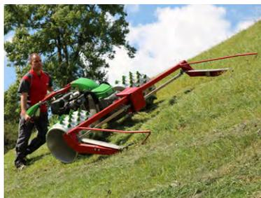
Les besoins de l'opérateur, lorsqu'il travaille avec des accessoires lourds, sont au centre de nos préoccupations chez Rapid Orbito. L'équilibre peut être ajusté avec l'axe réglable par simple pression sur une touche. L'appareil est d'utilisation simple et intuitive grâce aux éléments de commande disposés de façon ergonomique.
