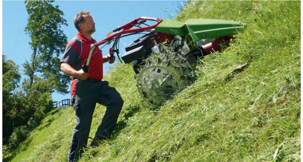
Le dispositif de fauchage relie l'accessoire barre de coupe au porte-outils mono-axe. Il sert d'unité d'entraînement pour les couteaux. Les différentes variantes de longueur, de manchon porte-outils, de hauteur de montage, de régime et de capot distributeur permettent un fonctionnement optimal des différentes barres de coupe sur tous les porte-outils mono-axe Rapid.
