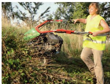
La Rapid SWISS est un porte-outils mono-axe léger, compact et très maniable. L'entraînement hydrostatique de manière continue et la direction active pilotée depuis le guidon assurent une maniabilité simple même dans les zones les plus difficiles. Le centre de gravité bas et le grand choix de pneumatiques font de la Rapid SWISS une machine efficace et sûre même dans les pentes les plus escarpées.
