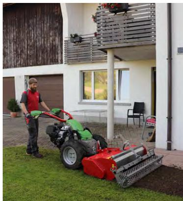
L'enfouisseuse Rapid permet d'enfouir en une seule opération le vieux gazon, les restes de plantes et les pierres dans le sol. La terre fine est amenée à la surface et le sol est de nouveau prêt pour les étapes suivantes. Grâce à son système de guidage optimal et sa parfaite adaptation sur les terrains irréguliers, l'enfouisseuse garantit un résultat propre.
