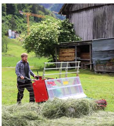
La Rapid Multi-Twister dispose d'un convoyeur à bande avec lequel le produit de fauche récolté à l'aide du pick-up éprouvé est évacué activement sur le côté. Une utilisation sur terrain plat ou en pente est donc envisageable. L'évacuation active accroît en outre le spectre d'utilisation quant au fourrage vert et à l'ensilage. De même, le convoyeur à bande permet de mettre en œuvre la technique de «l'andainage».
