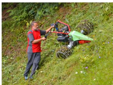
Avec la Rapid REX, vous pouvez maintenant travailler efficacement là où jusqu'à présent seule la faux pouvait être utilisée. Grâce à son poids de seulement 85 kg et son centre de gravité bas, il est possible de s'attaquer à des pentes jusqu'à 120% en toute sécurité. Avec le guidon à direction active, les manœuvres précises sont faciles et sûres même sur des terrains difficiles.
