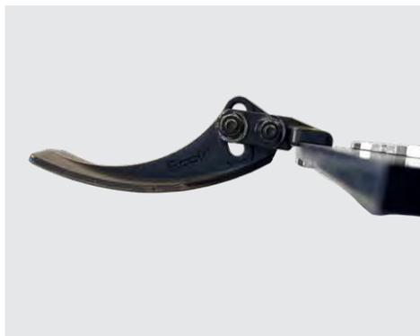
Le sabot se trouve derrière la barre de coupe et se règle en continu pour une hauteur de chaume de 4 - 8 cm
