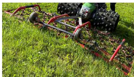
La version à châssis en plusieurs parties offre des propriétés supplémentaires. Lors de l'utilisation, les sections individuelles du châssis s'adaptent bien au terrain, même sur des surfaces accidentées.
