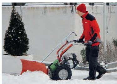
Les lames à neige de Rapid se distinguent par leur utilisation simple et sûre. Avec un mécanisme de pivotement à commande depuis le guidon, la neige est poussée efficacement dans la direction désirée. Grâce aux oreilles latérales avec montage sans outil, un déblaiement sans reste de grandes surfaces est possible.
