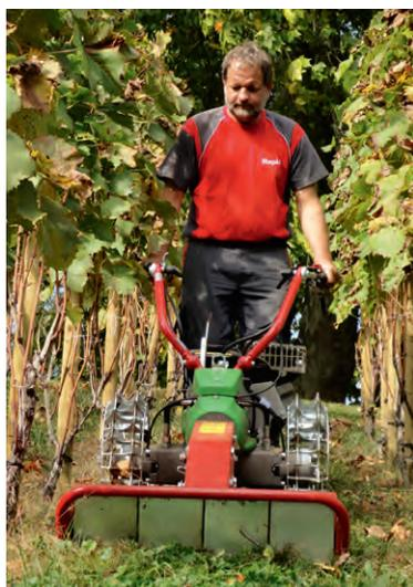
Les débroussailleuses écologiques Rapid conviennent parfaitement pour le mulching des broussailles et des espaces verts. Les lames en acier massif tournant horizontalement ont une performance de coupe élevée. Le produit de coupe finement haché est généralement laissé au sol. Cette manière de travailler permet un entretien rapide et propre des différents types d'espaces verts.
