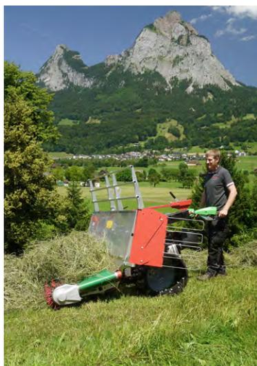
La faucheuse compacte Rapid Monta est conçue pour fournir un grand rendement surfacique sur les pentes de montagne escarpées. Un centre de gravité bas, le poids d'appui élevé de la barre obtenu grâce à la position de l'axe et le nouveau palier de guidon souple («Soft») de Rapid permettent un travail efficace avec un minimum d'efforts même lorsque la Rapid Monta est utilisée longuement.
