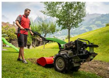
La fraise à terre Rapid fraise les sols cultivés ou préparés, broie les éléments du sol et mélange les horizons de sol. Le domaine d'utilisation de cette machine de travail du sol est vaste et s'étend du travail du sol de base, en passant par l'ensemencement et la plantation jusqu'à l'incorporation de matières organiques ou d'engrais.
