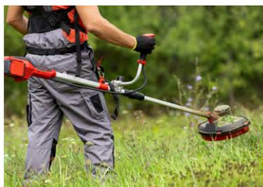
**Barre de coupe ou débroussailleuse:** Si l'on compare l'utilisation d'une barre de coupe communale sur un porte-outils mono-axe à celle d'une débroussailleuse, on constate des avantages en termes d'efficacité, de consommation de carburant, de pollution de l'environnement, de respect des petits organismes vivants, de zone de danger et d'influence sur l'utilisateur.
