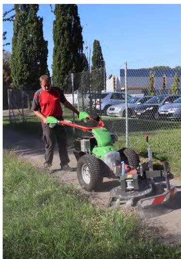
La brosse à mauvaise herbe permet de débarrasser les bordures, les coins et les surfaces stabilisées des mauvaises herbes. Cela permet de maintenir la propreté, la sécurité et la protection des bâtiments. Les fonctions de drainage sont conservées et l'accumulation de sédiment est évitée au niveau des bordures de trottoir et des caniveaux. Cette méthode arrache la mauvaise herbe par une action mécanique réalisée dans plusieurs sens et la dépose sur la surface.
