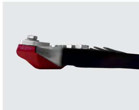
Le sabot de serrage se trouve sous la barre de coupe et ne se règle pas, pour une hauteur de chaume d'environ 6 cm
