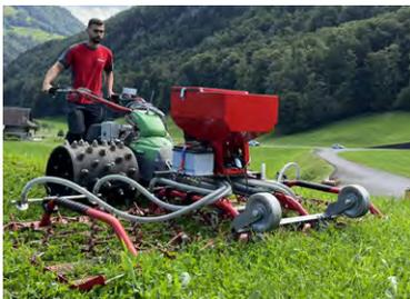
Avec le support de fixation de semoir en option, il est possible d'installer un semoir disponible dans le commerce et de ré-ensemencer ou sursemmer en même temps.
