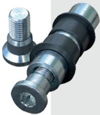
Les articulations du parallélogramme X-Control sont équipées d'axes coniques dotés de bagues en polymère. Ces éléments assurent une précision latérale exemplaire au niveau du porte-dents. Contrairement à un axe simple, qu'il soit muni ou non de bagues, ces axes coniques offrent une précision et une durabilité nettement supérieures.
