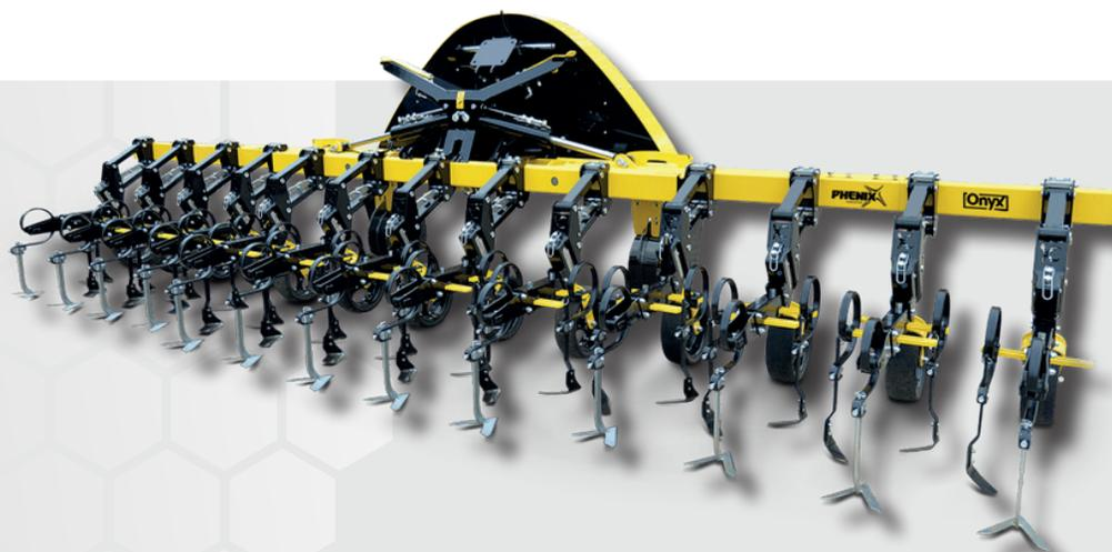
X-CONTROL, système de report de charge du châssis avec réglage de la hauteur et de la pression, pour un travail précis, sans pianotage de l'élément.
