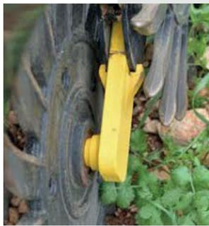
Il est court pour permettre aux étoiles de travailler les unes dans les autres et d'accentuer ainsi leur action sur la surface. Son palier surdimensionné résiste à une utilisation intensive. Ses guides garantissent un alignement parfait des étoiles dans l'axe d'avancement, même avec les contraintes latérales.
