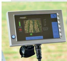
Une seconde caméra peut être installée de l'autre côté de la bineuse pour pallier une culture irrégulière. L'intérêt est plus important sur de grandes largeurs.
