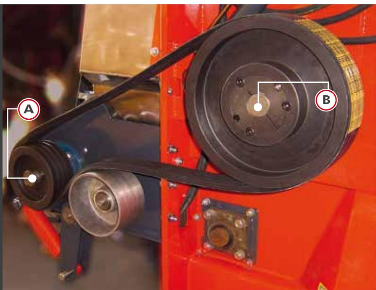
EMPLACEMENTS DES CAPTEURS : **POULIE A ET B**
