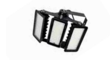
Les puces LED de grande puissance en céramique génèrent une lumière à 5 600 K, produisant 135 lumens par watt. La construction en céramique et en aluminium avec des ailettes de refroidissement est thermo-laquée. Une robuste vitre en verre, sécurisée par des vis spéciales sur tous les côtés, permet d'étancher l'intérieur de la lampe et d'obtenir une classe de protection IP65. Les supports de suspension sont en acier inoxydable et
