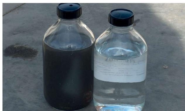
Effluents avant et après traitement par BFBulles®
