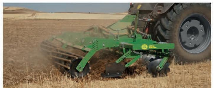
**DÉCHAUMEUR RAPIDE:** Déchaumeur rapide de 3 à 6 mètres avec disques de 22 ou 24 pouces. Machine portée, attelage 3 points du tracteur. Léger, très robuste, idéal pour tous types de terrain.
