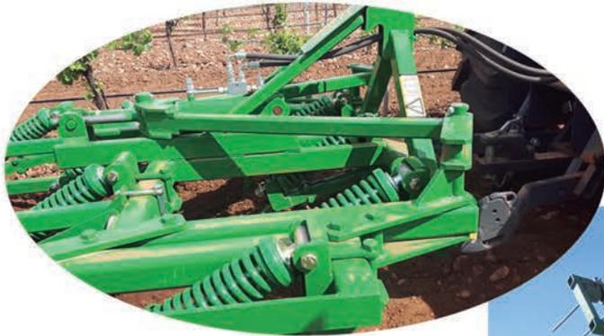
**CHMV extensible:** Cultivateur vigne à châssis extensible, sur châssis 80x80 et bras 30x30, idéal pour les agriculteurs qui ont différents types de plantations et des terres moins travaillées. Disponible avec rouleau ou herse et troisième point avec élévation hydraulique.
