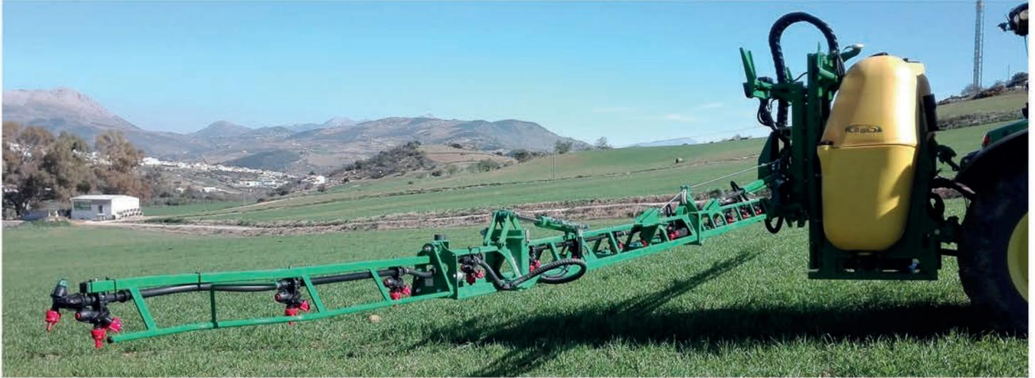
**TELENO:** Pulvérisateur suspendu, cuve en polyéthylène, châssis en acier hautement élastique, pompes à membrane, agitateur hydraulique, commandes électriques et ordinateurs de précision, lave mains, lave circuits, lavage interne, incorporateur de produit avec lave récipients. Elévateur et suspension, porte buses trijet, et barres en aluminium ou métalliques de différentes largeurs de travail.
