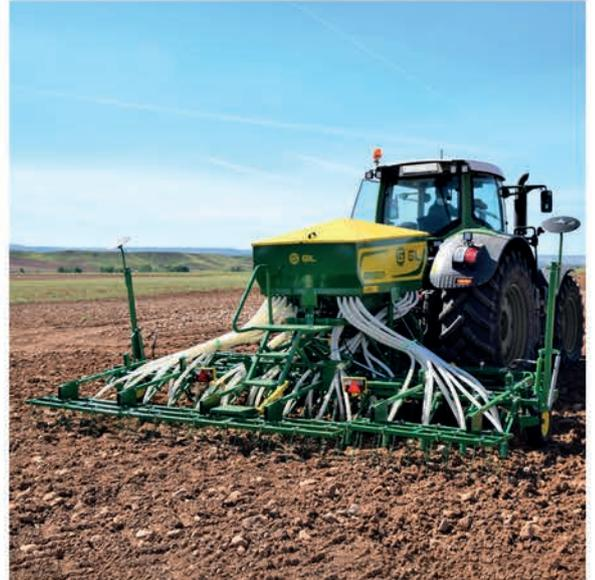
**AIRSEM PRO:** Semoir pneumatique porté, le semoir le plus polyvalent de notre gamme. Destiné aux agriculteurs avec différents types de sol, puisque le soc PRO est conçu pour effectuer un travail magnifique sur tout type de terrain. Train à 3 rangs, en trois corps articulés à bras indépendants avec ressort simple (double ressort en option).
