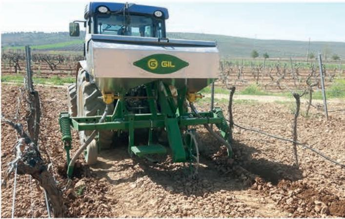
**ENGRAIS LOCALISATEUR AL:** Épandeur localisateur pour les cultures ligneuses trémie en acier inoxydable, roue motrice avec ressort pour assurer un dosage proportionnel à l'avancement sur tous types de terrain. Deux bras sur châssis télescopique par fractions de 10 cm., pour s'adapter au cadre de plantation. Roues de contrôle de profondeur et passerelle de remplissage.
