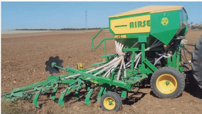
**ÉQUIPEMENT POUR ENGRAIS MICROGRANULÉS:** Trémie pour engrais micro granulés ou petites graines, distributeurs cannelés, pour semoirs pneumatiques.
