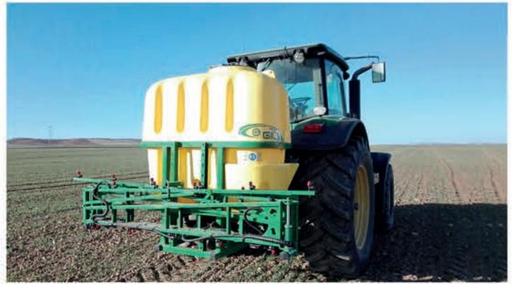
**ABANTOS:** Pulvérisateur traîné avec châssis en acier à hautes limites d'élasticité, cuves en polyéthylène, réservoir lave-mains, lave-circuits, nettoyage intérieur, incorporateur de produit avec lavage et lave récipients, élévateur à parallélogramme, arbre extensible, suspension aux barres et à l'essieux, barres verticales en aluminium et parallèles métalliques avec buses trijet.
