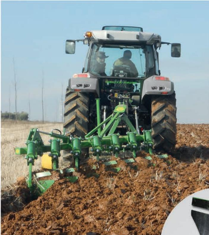
**ACH:** Charrue déchaumeuse à double ressort avec profondeur de labour de 20 cm. Idéal pour les travaux de conservation des sols. Grand dégagement, largeur fixe. Séparation des corps 32 cm.
