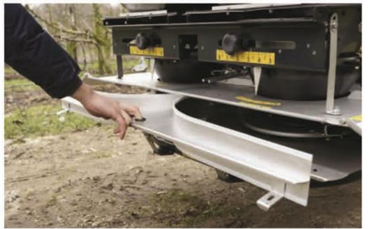
**EPANDEUR CENTRIFUGE JOLLY-F:** Epandeur centrifuge à double disque avec largeur de travail en bandes de 10 m, et en champs ouverts de 18m. Fermeture des disques hydrauliquement depuis le tracteur. Disques et alimentateur en acier inoxydable et système vibratoire pour empêcher l'agglutination du produit.
