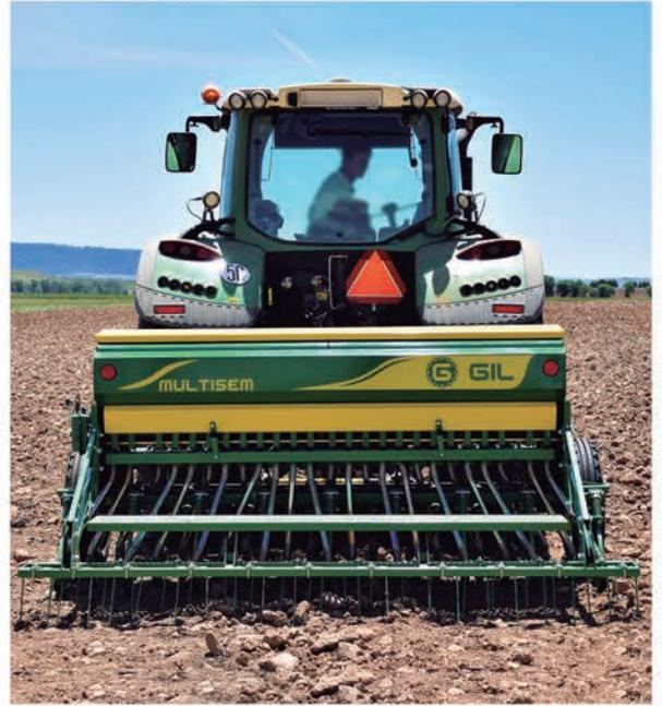
**GTA:** Semoir mécanique conventionnel combiné de haute précision. Basé sur la robustesse et la précision du semoir GT, avec la différence de la trémie combinée. Trémie de grande capacité pouvant combiner grain et engrais pour une efficacité maximale. Distributeur à ergot et variateur de vitesse pour grain et engrais. Tubes télescopiques en acier inoxydable.
