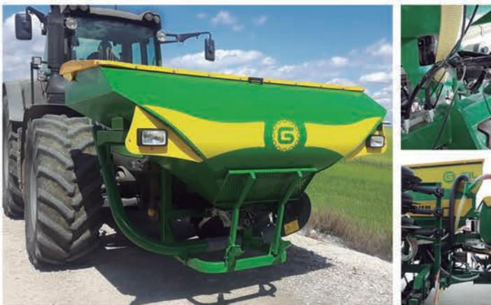
**TRÉMIE FRONTALE (TD-AIRSEM):** Trémie d'une capacité de 1.900 L. avec entraînement hydraulique, elle se monte sur le trois points avant, avec feux de transport. Pour le transfert du produit vers la trémie du semoir ou de l'épandeur d'engrais attelé au tracteur. La version DIST dispose d'un distributeur pour doser le grain ou l'engrais et l'incorporer au système pneumatique du semoir arrière.
