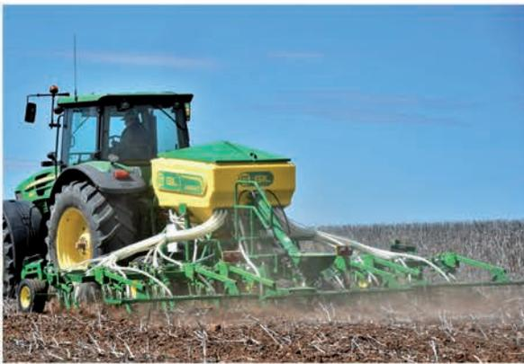
**AIRSEM-4F-SNL:** Semoir porté pneumatique en semis direct à soc en 4 rangs pour travailler sur de grandes accumulations de déchets, sans aucun problème de bourrage. Soc en T inversée avec pointe en tungstène qui facilite la fermeture du sillon. En option, différentes herse et roues de compactage.
