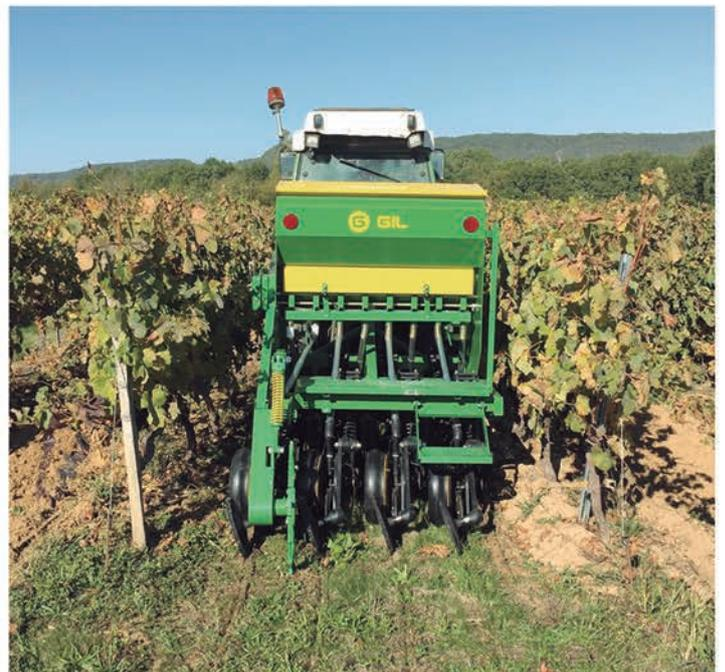
**SNLV-D:** Semoir mécanique à semis direct pour vignes à disque, système mono disque, avec roue de compactage et roue de fermeture du sillon, variateur de vitesse, distributeur à double ergot, plateau de pesée et tubes de descente télescopiques en métal. Disques de nettoyage en option pour terrain humide et/ou roue de compactage des graines en fer. Trémie de micro graines en option.
