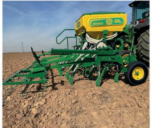
**AIRSEM-XL/XLC:** Semoir pneumatique traîné de grande capacité (6.000 l.) Entraînement du ventilateur par moteur hydraulique. Contrôle de profondeur aux 4 roues. Entraînement du distributeur par moteur électrique. Relevage arrière pour échanger différents trains de semis. Option de bras à double disque. Version XLC (combinée) d'une capacité de 3.650 l. de grains et 2.350 l. d'engrais.
