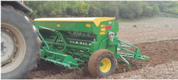
**PRE-CULTIVATEUR AVANT:** Pré cultivateur fixé devant les semoirs mécaniques conventionnels, à bras indépendant à ressort, répartis sur deux rangs, pour préparer le lit de semence et économiser un passage
