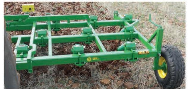
**CHM-100:** Cultichisel moyen renforcé, étant un cultivateur de type moyen, idéal pour les labours secondaires, grâce à son châssis renforcé 100x100 et son bras haut 40x30, il est capable d'effectuer des labours plus forts, atteignant dans de bonnes conditions les travaux primaires de relèvement de chaume. Il est disponible en versions 2 et 3 rangs.
