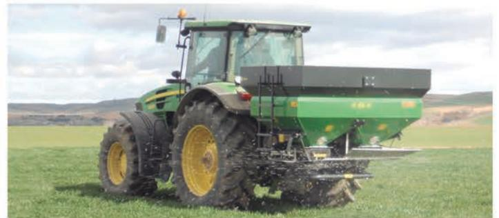
**ÉPANDÉUR D'ENGRAIS JOLLY ET DPA:** Épandeur d'engrais centrifuge à double disque avec une largeur de travail de 24 m. Fermetures des disques hydrauliquement depuis le tracteur. Disques et alimentateurs en acier inoxydable et système vibrant pour éviter l'agglomération du produit. La version JOLLY-DPA a une ouverture automatique selon la vitesse du tracteur pour maintenir une dose homogène.
