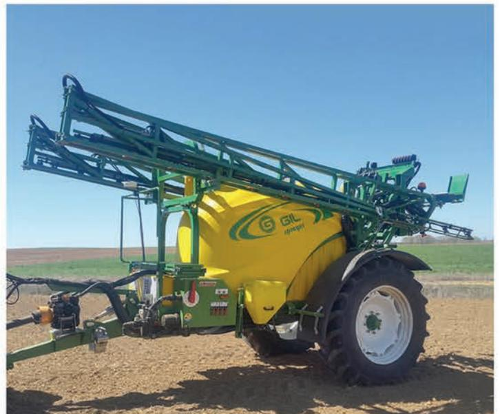
**CUVE AVANT:** Cuve en polyéthylène haute densité pour augmenter l'autonomie du traitement, sur châssis fabriqué en acier à haute limite d'élasticité, filtre de remplissage et d'aspiration, pompe à commande hydraulique pour le transfert ou l'agitation avec électrovanne actionnée par commande électrique dans la cabine. Avec cette pompe, nous avons la possibilité de charger à la fois le réservoir avant et le réservoir arrière.
