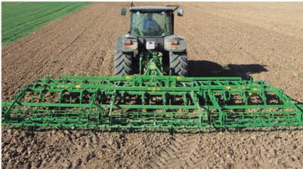
**CHLG:** Cultichisel léger équipé d'élastomères, conçu spécialement pour la préparation du lit de semis, qui associé au rouleau et à la herse assure une magnifique porosité et un très bon compactage avant semis. Bras 25x25. Disponible en 2, 3 et 4 rangées.
