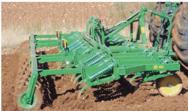
**CHMG:** Outil équipé d'élastomères, en remplacement des ressorts classiques de notre gamme, pour moins d'entretien. Il a les mêmes caractéristiques que notre cultichisel le plus polyvalent, le CHM.
