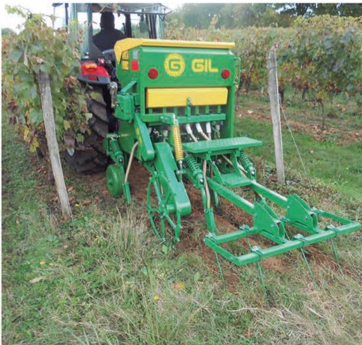
**SNLV:** Semoir mécanique de semis direct à soc pour la vigne, soc en T inversé avec pointe en tungstène, variateur de vitesse, distributeur à double ergot, plateau de pesage et tube de descente métalliques. Trémie de micro granulé en option.
