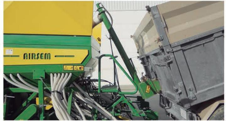
**VIS SANS FIN HYDRAULIQUE:** Vis sans fin hydrauliques pour grains ou engrais dans un tube de 127mm de diamètre à installer sur les remorques.
