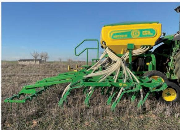
**AIRSEM-PRO-4F:** Semoir pneumatique porté, le semoir le plus polyvalent de notre gamme. Destiné aux agriculteurs avec différents types de sol, puisque le soc PRO est conçu pour effectuer un travail magnifique sur tout type de terrain. Train à 4 rangs, en trois corps articulés à bras indépendants avec ressort simple (ressort double en option)
