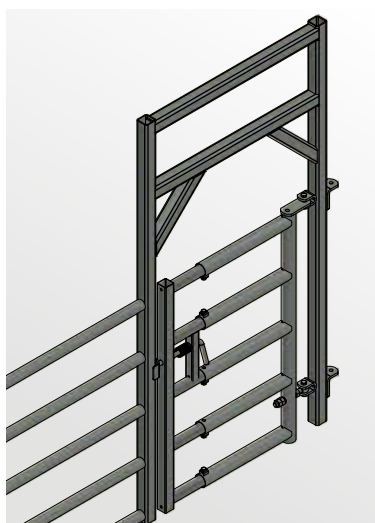
Portillon inclus dans un cadre renforcé en tube 60x60 mm.
