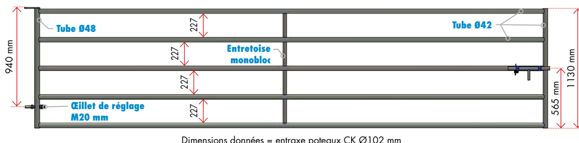
Cillet de réglage M20 mm avec trou Ø16 mm
