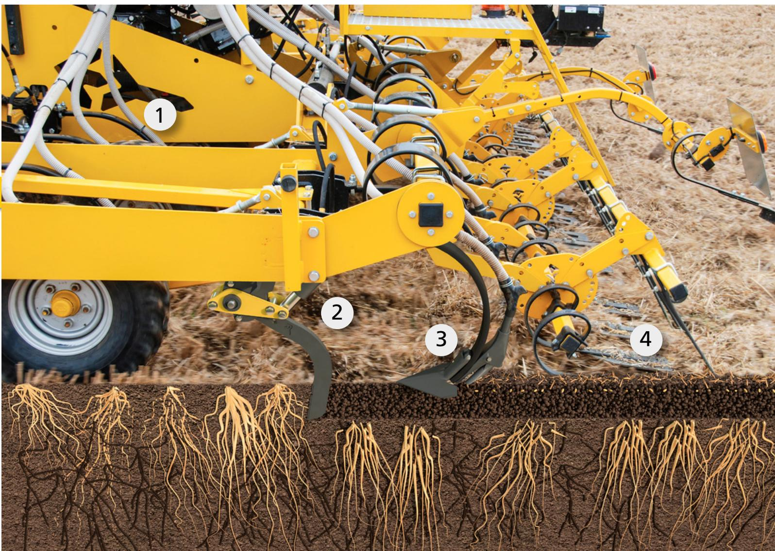
1. Les roues de profondeur en position centrale apportent un semis très précis puisqu'elles roulent sur un sol non travaillé entre les rangs et pas par-dessus la zone ensemencée.
