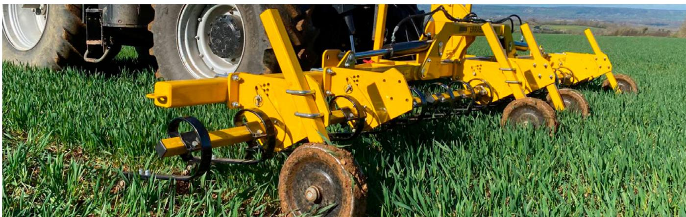
La bineuse TerraBlade offre une méthode de desherbage mécanique, à bas coûts, pour toute culture semée en bandes. C'est une arme supplémentaire dans l'arsenal de lutte contre les mauvaises herbes à un moment où l'efficacité des herbicides diminue avec les résistances bien que leurs coûts augmentent.
