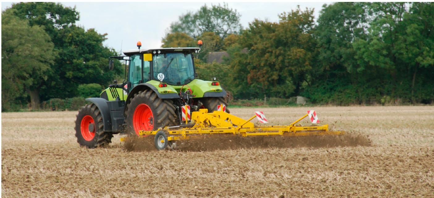
En déplaçant plus de matière que la herse à paille Claydon, le TerraStar® travaille par arrachement et laisse la structure du sol aérée mais intacte.
