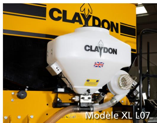
La trémie en plastique moulé a une capacité de 200 litres. Elle est totalement intégrée au circuit hydraulique du semoir pour alimenter la soufflerie. Ce semoir utilise le boîtier de contrôle Artemis permettant le calibrage et la variation de dose par GPS sur tous les produits.
