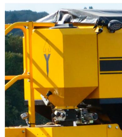
Le distributeur offre une capacité de 90 litres ; il est entraîné électroniquement et peut être programmé pour de la modulation de dose. Il est commandé ISOCAN/ ISOBUS au niveau de la console en cabine.
