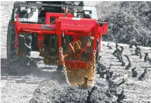
**GMV Champenoise équipée de chaîne arrière et déport hydraulique**
