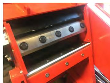
**Détail du rotor avec couteaux et contre-couteaux**
