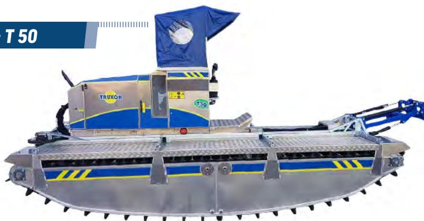
Sa flottaison est assurée par deux pontons creux en aluminium. Ses chenilles munies de palettes en composite assurent le déplacement aussi bien sur la terre que sur l'eau. D'un poids contenu, inférieur à 1 500 kg, Truxor se comporte comme un bateau sur les plans d'eau et les rivières, mais il est aussi capable de se déplacer et travailler dans les marais et les milieux sensibles sans dégrader l'environnement.
