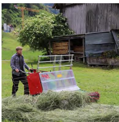
La Rapid Multi-Twister dispose d'un convoyeur à bande avec lequel le produit de fauche récolté à l'aide du pick-up à doigts est évacué activement sur le côté. Une utilisation sur terrain plat ou en pente est donc envisageable. L'évacuation active accroît en outre le spectre d'utilisation au fourrage vert et à l'ensilage. De plus, le convoyeur à bande permet l'utilisation du Multi-Twister pour l'andainage.
