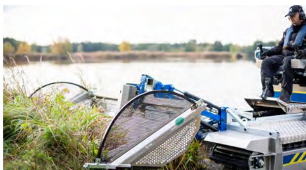
Le Doro Cutter ESM 50 coupe et collecte simultanément les plantes, idéal pour les espaces réduits tels que les petits cours d'eau ou canaux étroits. Son bac de collecte en aluminium perforé est amovible pour une utilisation dédiée à la coupe. Équipé de lames Busati à double action, il coupe les végétations ligneuses jusqu'à 2 cm d'épaisseur.
