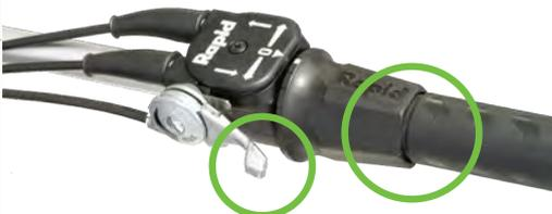
Avancement hydrostatique progressif par poignée tournante.
