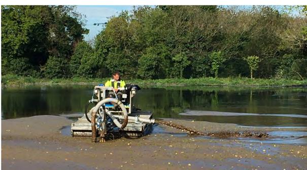
Une puissante pompe hydraulique permet de réaliser du dragage ou de l'hydrocurage pour désenvaser vos étangs ou curer des lagunes.
