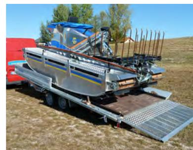
Transportable aisément sur une remorque plateau, avec permis EB. Facilité de mise à l'eau et d'accès aux chantiers grâce à ses propriétés amphibie.
