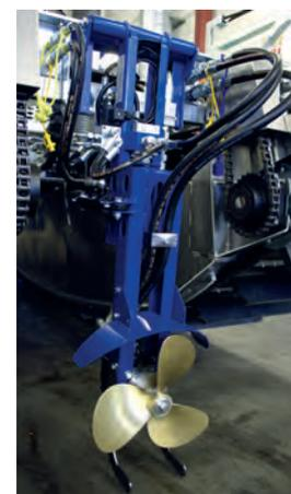
**Une hélice arrière, en option, permet d'augmenter la vitesse de déplacement sur l'eau.**
