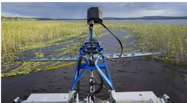
Faucardage des plantes aquatiques avec des barres de coupe (jusqu'à 4 mètres de large et jusqu'à 2,10 mètres de profondeur).
