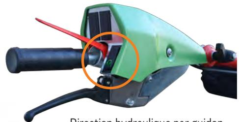
Direction hydraulique par guidon actif ou par leviers, sélectionnable en fonction des conditions de travail (selon modèles).
