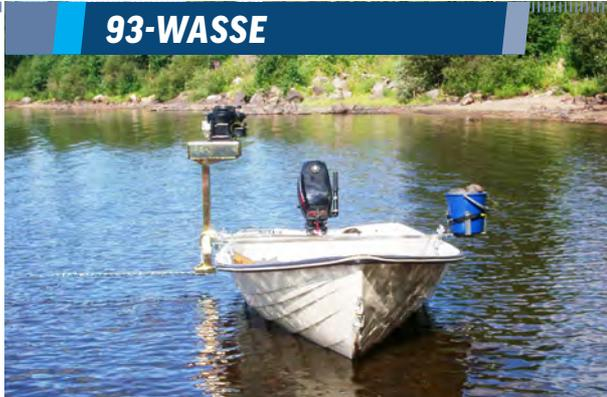
Particulièrement adaptée aux petites surfaces, étangs peu profonds ou les platières à gibiers d'eau avec sa largeur de coupe de 1 m pour une profondeur de 30 cm.
