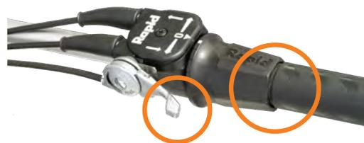
Avancement hydrostatique progressif par poignée tournante.
