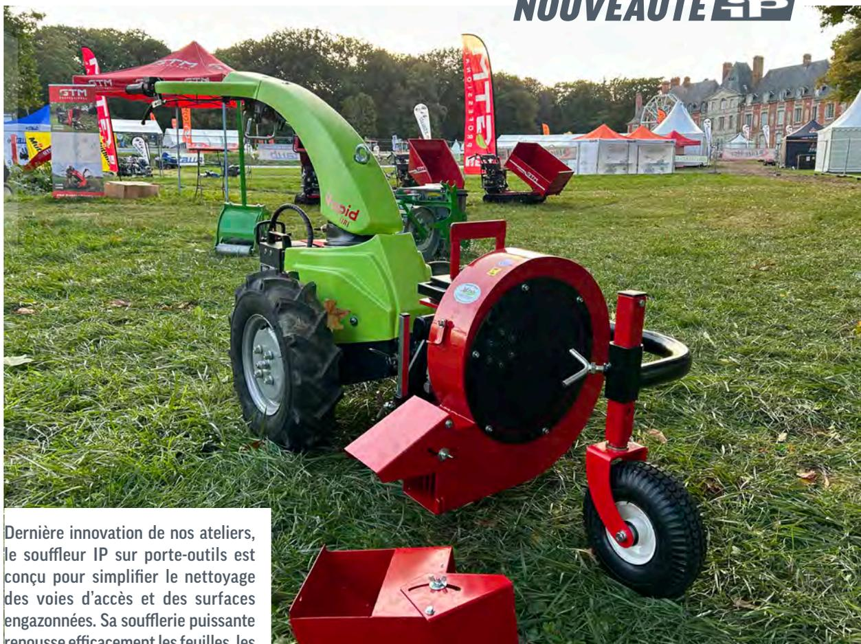
Dernière innovation de nos ateliers, le souffleur IP sur porte-outils est conçu pour simplifier le nettoyage des voies d'accès et des surfaces engazonnées. Sa soufflerie puissante repousse efficacement les feuilles, les adventices arrachés et autres débris, les dirigeant sur le côté ou vers l'avant, afin de créer des tas faciles à ramasser.
