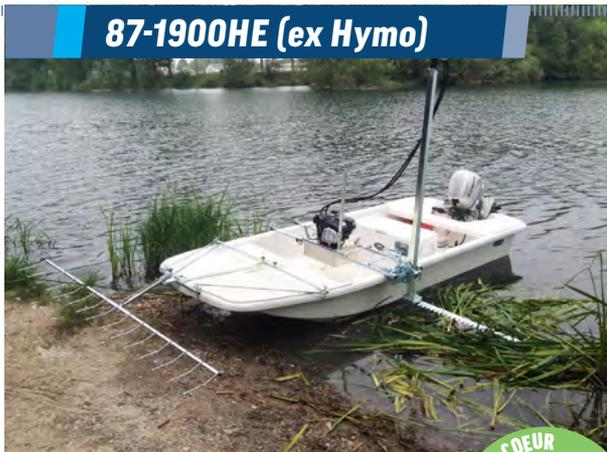
La coupe latérale permet de faucarder jusqu'à 1.90 m de profondeur sur une largeur de 1.50 m.
