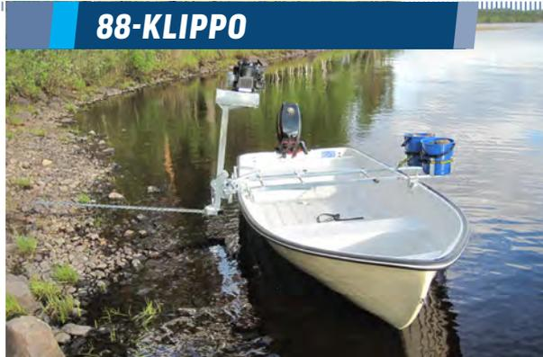
Idéale pour les étangs peu profonds. Barre inclinable pour travailler au plus près des berges. Largeur 1.50 m, profondeur 50 cm.
