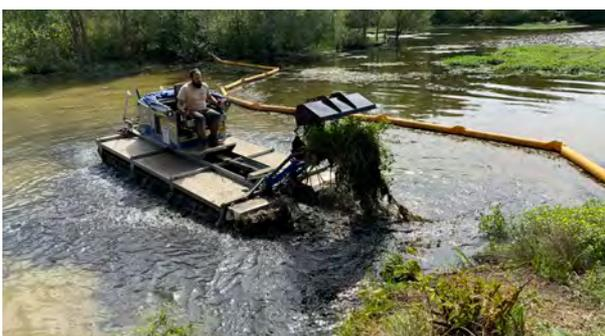
Divers râteaux et grappins permettent de réaliser l'arrachage et l'évacuation de plantes invasives type Jussie.
