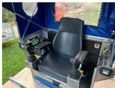
Cabine confortable et ergonomique. Gestion par joystick de toutes les fonctions depuis le poste de conduite.
