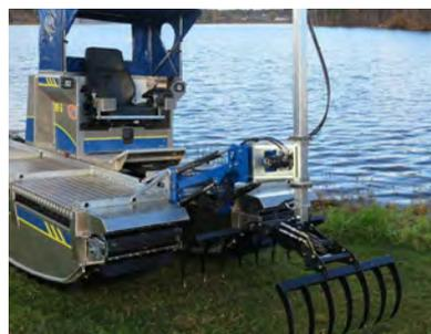
Bras d'attelage frontal type parallélogramme, avec de nombreuses prises hydrauliques pour alimenter les accessoires.
