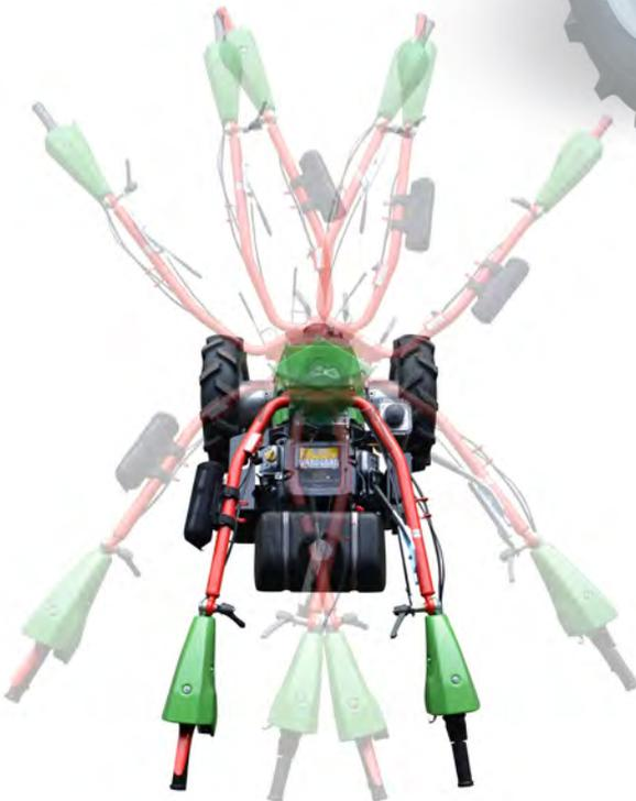
Guidon réglable en hauteur, déportable et/ou rotatif (selon modèle).
