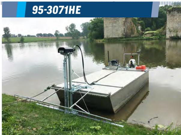
La barre de coupe frontale de type double lames à mouvement alternatif permet d'attaquer les végétations les plus denses jusqu'à 1.20 m de profondeur sans bourrage grâce à la lame verticale de division.
