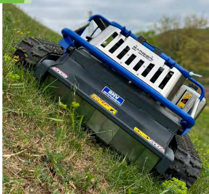
Tout aussi puissant que le X-Rot 95, le X-Flail 80 EVO possède un système de coupe à fléaux et axe horizontal permettant de faucher et débroussailler une végétation plus installée. Comme toute la famille "X" l'avancement est hybride avec 2 moteurs électriques alimentés par une génératrice. Idéale pour des pentes de 35 à 45°, sa garde au sol et son poids lui assure une grande maniabilité en pente ainsi qu'un excellent rendement.
