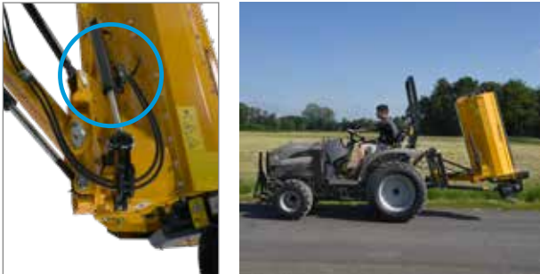
Verrouillage de transport de sécurité pour la conduite sur route ou lors du transport de l'attelage avec une remorque de véhicule particulier.
