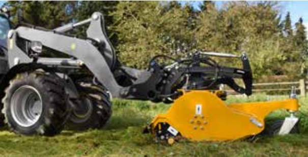
Un point de traction virtuel – Un brevet Mühling : le broyeur est tracté avec une faible résistance au roulement au lieu d'être poussé, ce qui lui permet de suivre parfaitement le contour de sol en toute situation.
