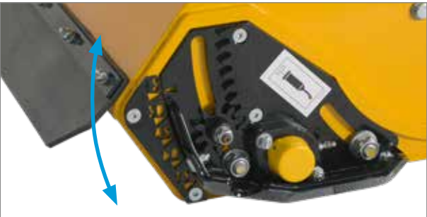
Réglage rapide de la hauteur de coupe à l'aide d'un seul outil : desserrer le raccord à vis / ajuster la hauteur de coupe / serrer le raccord à vis.
