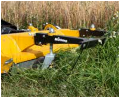
Sauveteur d'insectes de série monté à l'avant.
