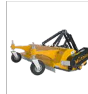
Le MU-C pour montage frontal : points de couplage bas et un boîtier surbaissé (vitesse monorapport de 1.000 ou 2.000 tr/min).
