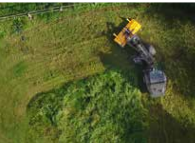
Marche à vide ingénieuse dans les virages, car la machine suit le rayon de braquage.
