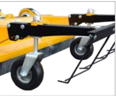
Roues d'appui réglables en hauteur, pivotant sur 360 degrés
