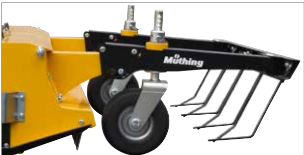
Les roues de support avant de série facilitent la manipulation et améliorent le suivi du sol. Elles sont réglables en hauteur et pivotantes à 360°. Un sauveteur d'insectes monté en amont est disponible en option.
