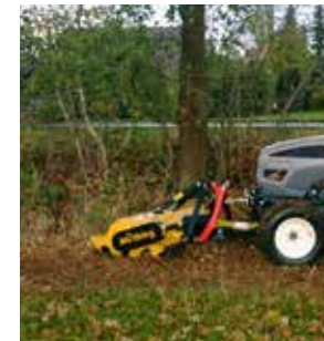
Le MU-C pour montage frontal : points de couplage bas et un boîtier surbaissé (vitesse monorapport de 1.000 ou 2.000 tr/min).
