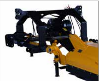
La tête d'attelage frontale / arrière robuste permet un usage flexible à l'avant ou à l'arrière du tracteur / véhicule porteur (en option).
