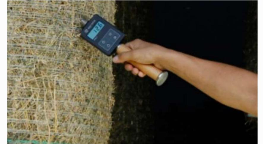
Le testeur de foin/paille, mesure rapidement l'humidité et la température lors de la récolte et du stockage. Avec sa sonde inox et son manche en bois, il fournit des résultats en quelques secondes, avec une alarme sonore paramétrable pour un contrôle optimal.
