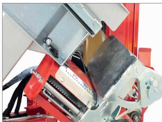
Butée en sortie de chevalet avec capteur de présence de bûches pour l'automatisation du basculement du chevalet
