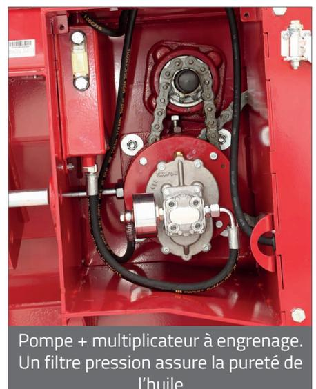
Pompe + multiplicateur à engrenage. Un filtre pression assure la pureté de l'huile
