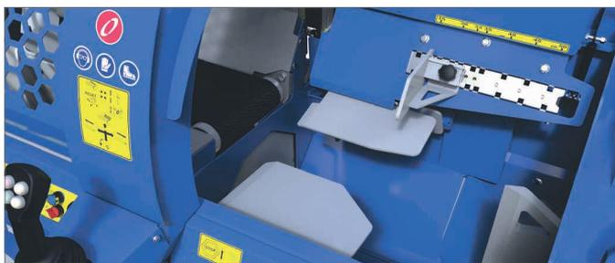
La butée hydraulique de longueur de coupe réglable de 25 à 50 cm.
