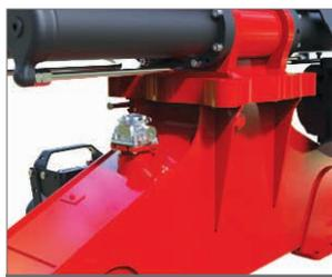
Les filtres pression et retour assurent la propreté adéquate de l'huile dans le système hydraulique.
