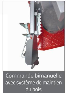
Commande bimanuelle avec système de maintien du bois
