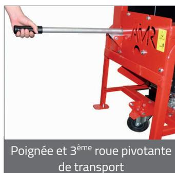
Poignée et 3<sup>ème</sup> roue pivotante de transport
