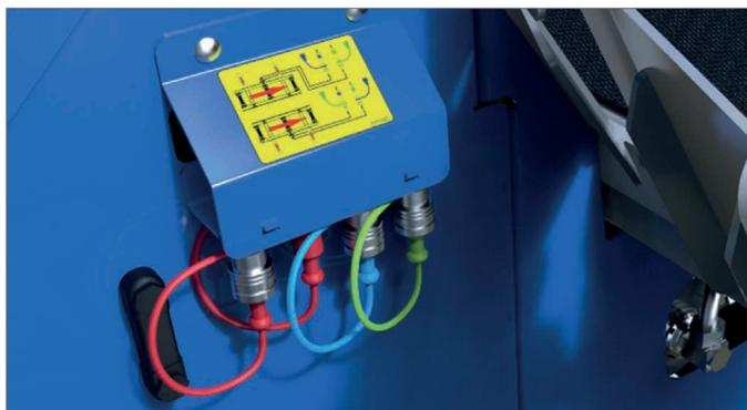
Sortie hydraulique pour deck ou autres accessoires.
