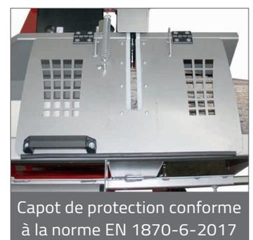
Capot de protection conforme à la norme EN 1870-6-2017
