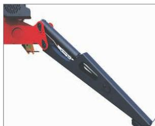
Vérins stabilisateurs avec soupapes de freinage intégrées
