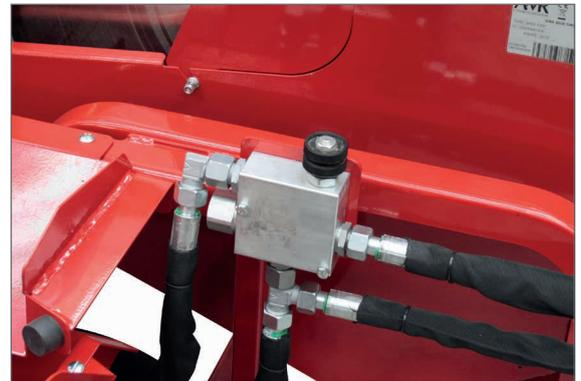
Réglage de la vitesse d'évacuation du tapis de série sur les 2 modèles de SCIAMAT
