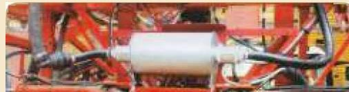
Le module plocher agro-katXL a été monté sur le tuyau de circulation du pulvérisateur
