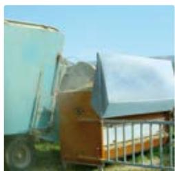
■ **Grand toit ouvrant pour faciliter le remplissage.** Le JBSF3030 dispose en plus d'un capot anti-projection utile avec la mélangeuse.
