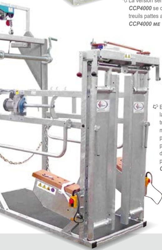
↳ En version **TE** (Toute Électrique), la **CCP3000** se parre de deux treuils pattes avant avec motoréducteurs à vitesse progressive munis d'une planche en bois traité ainsi que d'un treuil arrière électrique à position réglable **CCP3000 TE**
