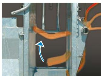
■ **Sous-ventrière mécanique** de grande dimension : Le veau ne peut pas se coucher. Plancher anti-dérapant.
