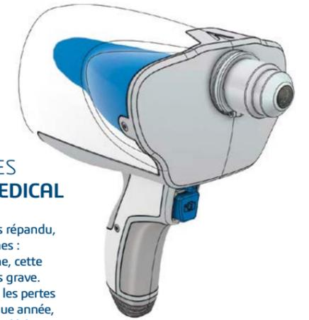
des images très similaires aux images histologiques traditionnelles. L'appareil portable repose sur une approche brevetée combinant la tomographie par cohérence optique (OCT) et la microscopie confocale par réflectance (CM), appelée LC-OCT (Line-field Confocal OCT). La startup française est accompagnée par le programme 3DEXPERIENCE Lab de Dassault Systèmes depuis novembre 2019.
