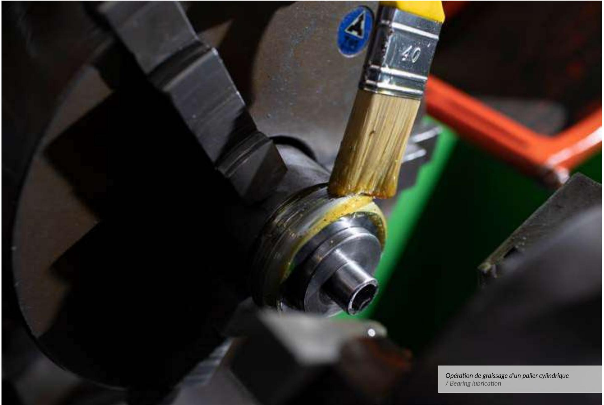
Opération de graissage d'un palier cylindrique
