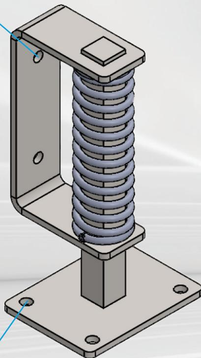
Trous de fixation roulette à platine
