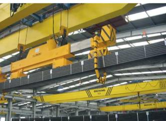
Nos porteurs magnétiques à aimants permanents vous permettent de soulever des charges allant jusqu'à 1 000 kg sans aucune source d'énergie. Nos produits sont conçus pour lever des formes plates ou rondes et d'épaisseurs variables. Ils sont généralement à activation manuelle avec anneaux de suspension et répondent aux normes CE.
