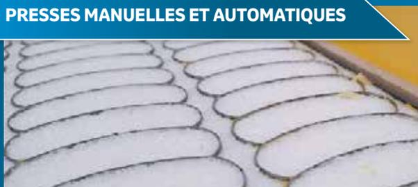
Nos technologies permettent de découper tous types de matériaux cellulaires : Polyuréthane, Polyéthylène, EPDM, et fibreux pour sortir une pièce en 2D et 3D.
