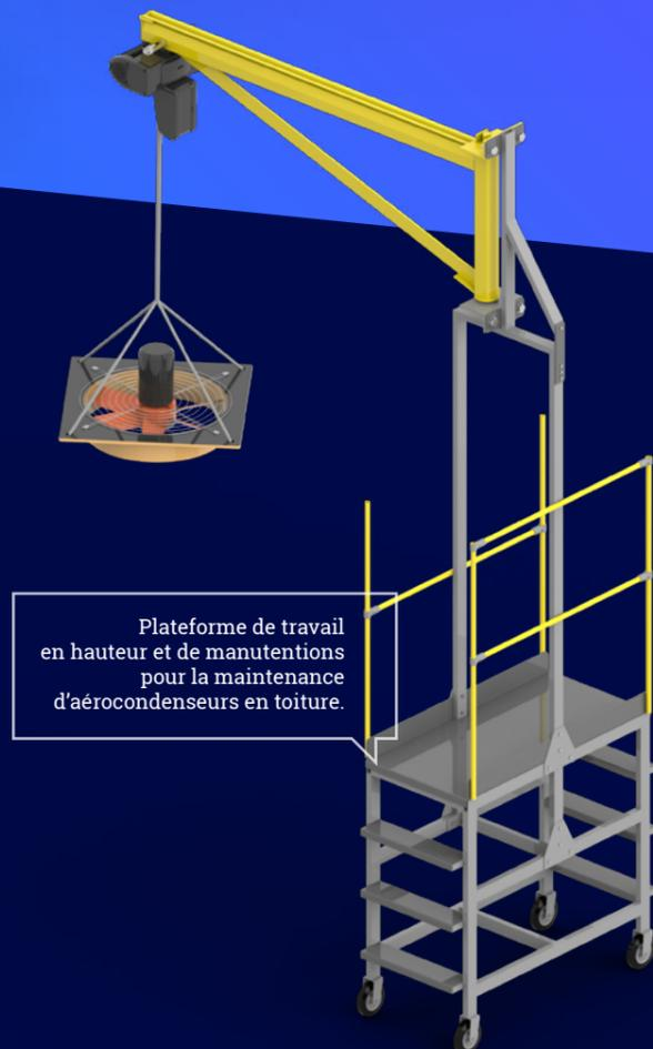
Plateforme de travail en hauteur et de manutentions pour la maintenance d'aérocondenseurs en toiture.
