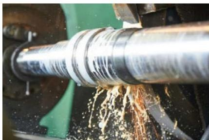
Le technicien en rectification industrielle produit des pièces unitaires ou de série, à partir de gammes de rectification et de contrôle déterminant les différentes opérations à effectuer (choix des outils, équipement de la meule, réglages de rectification, ...). Il peut également intervenir dans le cadre du lancement d'une première pièce lors d'un changement de série et est amené à suivre et conduire une ou plusieurs productions.
