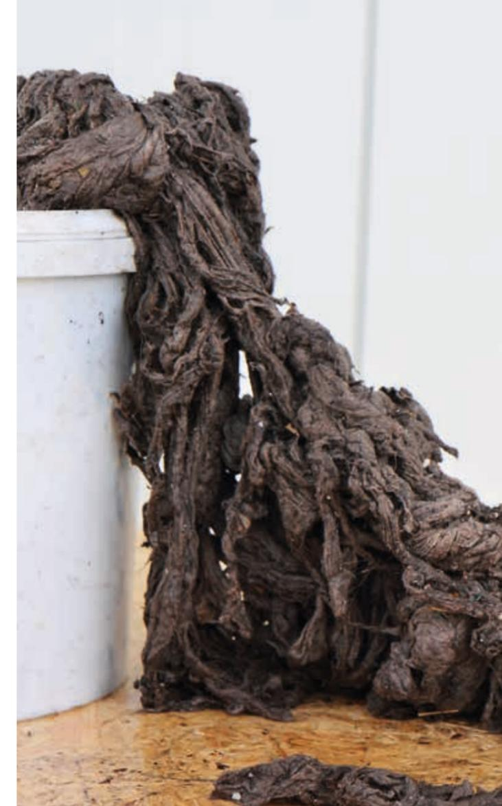
Les matériaux enchevêtrés comme les lingettes humides et les fibres provoquent des obstructions et des perturbations opérationnelles.
