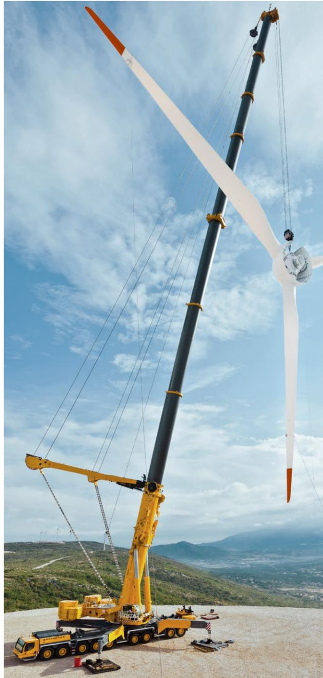
L'assemblage de machines de plusieurs tonnes, d'éléments de pont ou de pales d'éoliennes serait impossible sans les grues mobiles à flèche télescopique. Le bon lubrifiant est essentiel pour de nombreux aspects de ces opérations. L'espace de lubrification de la flèche télescopique est exposé à de nombreuses influences environnementales, aux polluants, à l'humidité ainsi qu'aux contraintes mécaniques de la neige et de la glace.
