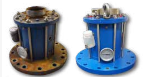
EXEMPLE DE RECONDITIONNEMENT D'UN BOÎTIER D'AGITATION
