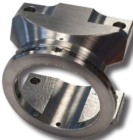
Pièce réalisée entièrement en **tournage 4 axes**
