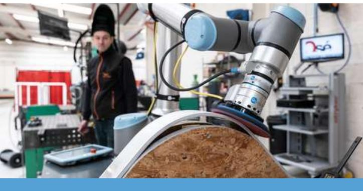
L'outil **Sander** d'OnRobot est une ponceuse électrique puissante fonctionnant sans air comprimé. Il a été spécialement conçu pour les applications collaboratives de nombreux domaines tels que : l'industrie du bois, l'automobile, l'aéronautique, la peinture, la tôlerie industrielle...
