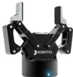
La pince électrique 2F85 à 2 doigts est conçue pour travailler avec la gamme de robots UR.
