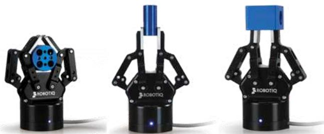
Leur design permet de **saisir les objets par l'extérieur ou l'intérieur** et de s'adapter aux pièces de révolution. Vous pouvez également **contrôler la force de serrage, la vitesse de fermeture et l'amplitude du mouvement**. La connexion au robot est possible via un port USB présent dans le contrôleur.
