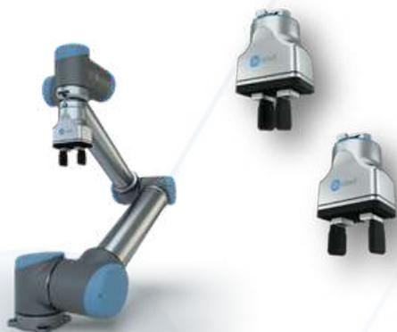
**Le préhenseur OnRobot 2FG7 est léger, compact, avec une charge utile élevée et une vitesse accrue.** Conçu pour les applications à environnement étroit et à accessibilité complexe, il peut être utilisé pour des missions variées.
