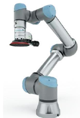
La ponceuse intelligente OnRobot simplifie et automatise les opérations de ponçage avec votre cobot Universal Robots. Son changeur de grains permet une commutation automatique des disques de ponçage, éliminant ainsi la nécessité d'intervenir manuellement. Les capacités de détection de l'outil permettent **une adaptation précise aux variations des surfaces**.
