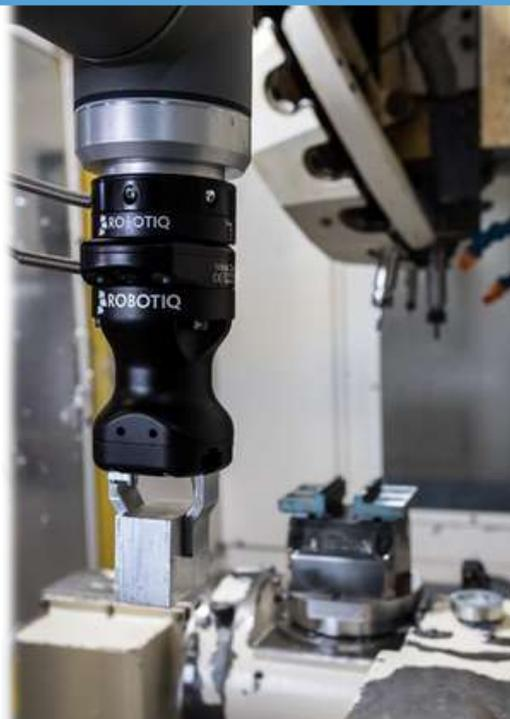
La pince électrique Hand E, spécialement conçue pour une intégration avec la gamme de robots UR est livrée avec trois types de mors interchangeables. Elle peut être enrichie avec le système de vision RWC de Robotiq, le capteur d'effort FT300 de Robotiq, ou une seconde pince Hand E pour les applications nécessitant une double saisie.
