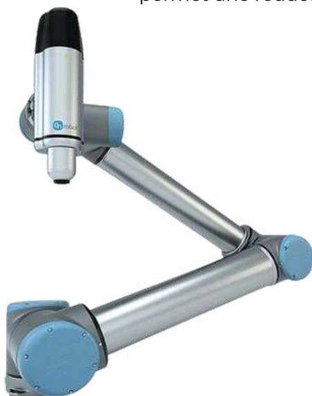
Spécifiquement **conçue pour des applications collaboratives**, la visseuse OnRobot Screwdriver intègre des **fonctionnalités de sécurité innovantes**. Elle **rétracte automatiquement la vis** pendant son mouvement, offrant une rétraction complète pour les vis jusqu'à 35 mm.
