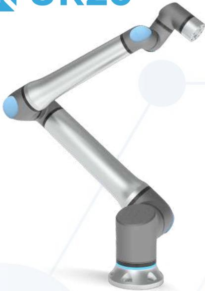
**Capacité de levage :** 20 kg
