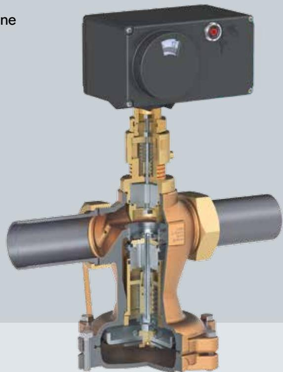
Les vannes de régulation indépendantes des variations de pression PICV (Pressure Independent Control Valve) assurent une bonne régulation de la température du circuit secondaire sur une grande plage de fonctionnement, tout en équilibrant le réseau par limitation du débit dans la sous-station.
