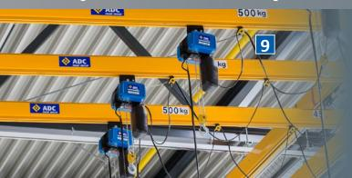
Composés de profils fabriqués par laminage à froid et d'accessoires de conception simple et modulables. La capacité maximum de levage est de 2t. Ces équipements peuvent être opérés manuellement ou électriquement.
