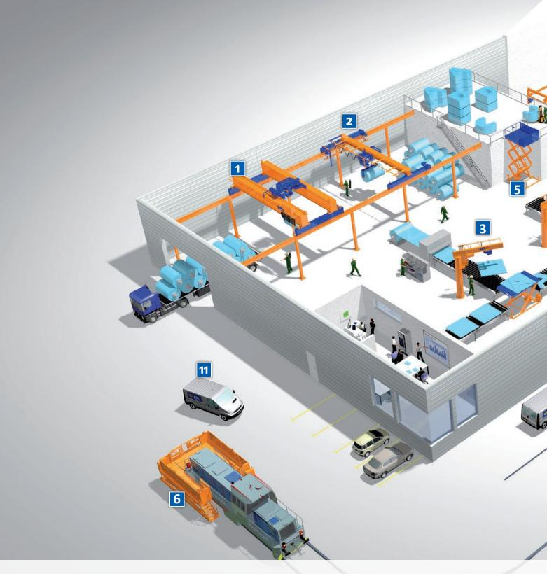
1 Pont roulant process 2 Pont roulant 3 Potence 4 Table de quai 5 Table élévatrice 6 Table mobile
