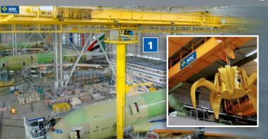
Ces matériels à hautes performances (capacité jusqu'à 400 tonnes et vitesse de levage jusqu'à 90 m/min) sont développés selon les cahiers des charges de nos clients. Un ingénieur d'affaires est alors attaché à l'élaboration, à la mise en œuvre et mise en service de votre installation.
