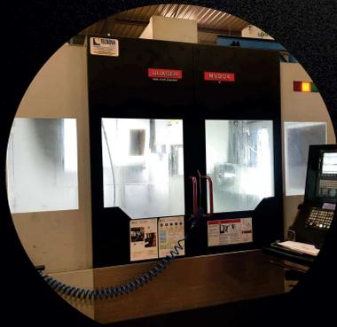
✓ **CENTRE D'USINAGE 4 AXES
